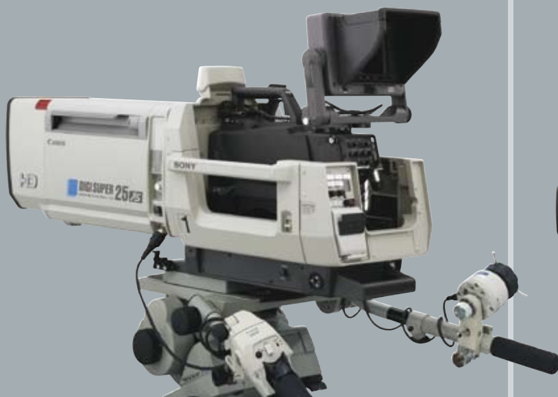
HDLA-1505 mit HDVF-C730W (Große Objektive und LCD-Sucher)
